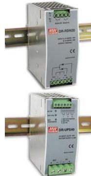
Модуль DR-RDN20 предназначен для параллельного подключения источников питания с выходным напряжением 24 В DC по схеме 1 + 1 или 1 + N для увеличения надежности и выходной мощности. На каждом входе имеются светодиодные индикаторы наличия напряжения. Предусмотрены контакты реле для индикации наличия выходного напряжения.
