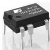
Многие электронные изделия содержат редко используемые двигатели, динамики или источники света, которые требуют дополнительной мощности лишь на короткий промежуток времени (двигатель DVD-плеера, открывающий лоток с диском). Микросхема TinySwitch-PK способна кратковременно удваивать рабочую частоту одновременно с увеличением ограничения по току, что позволяет получить до 280% от стандартной мощности при использовании того же самого трансформатора.
